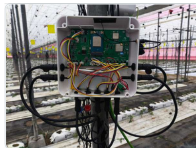
À l'intérieur du boîtier contenant des capteurs interconnectés et une carte de commande
